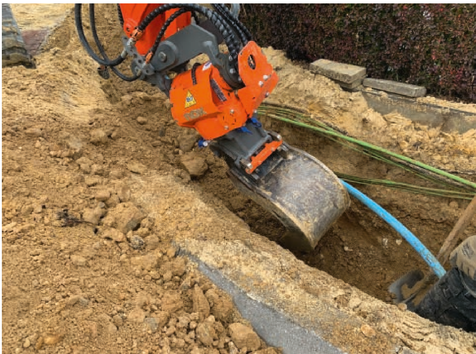
De NOX met 360° continue rotatie en 2 x 50° kantelhoek maken de graafmachine tot een multifunctionele alleskunner.
